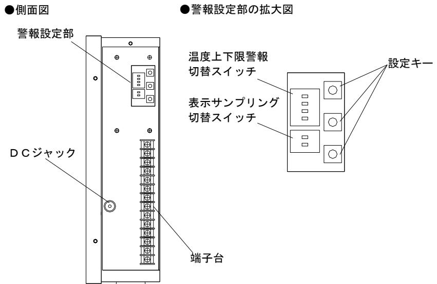
②警報スイッチ No1～No4（下図参照）を左側（OFF）の状態で表示器にACアダプタを接続して電源を入れてください。
