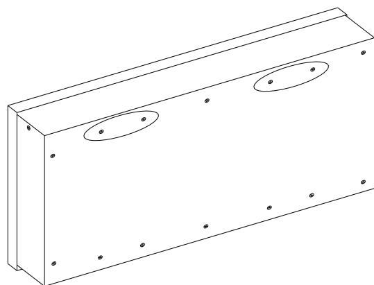
③吊り下げ金具(2ヶ)をネジ位置に合わせ、②で取り外したM3ネジでしっかりと締めつけてください。
