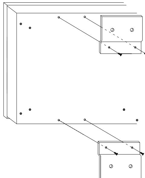
③コンクリート用ネジ(M3~6)などで、壁掛け金具の8箇所をしっかりと固定してください。
