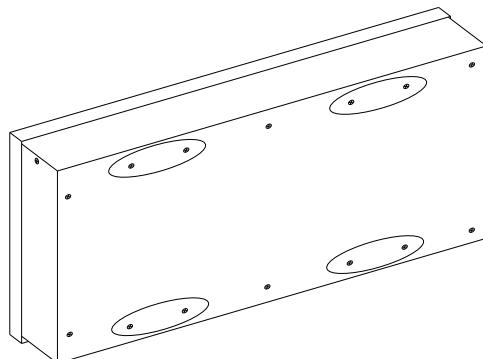
②付属の壁掛け金具(4ヶ)をネジ位置に合わせ、①で取り外したネジでしっかりと締めつけてください。
