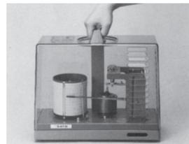
16. キャリングハンドルを、正面にまっすぐ向けて、アクリルカバーは、SK SATOのプレートが前にくるように取り付ける。
