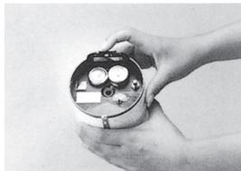
6. 電池の⊕⊖に注意し、円筒時計に確実に入れる。そして、電池ぶたを閉じてツマミを離してください。
