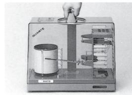
16. キャリングハンドルを、正面にまっすぐ向けて、アクリルカバーは、SK SATOのプレートが前にくるように取り付ける。
