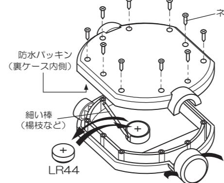
電池が消耗すると表示が薄くなるなど正確に動作しなくな
